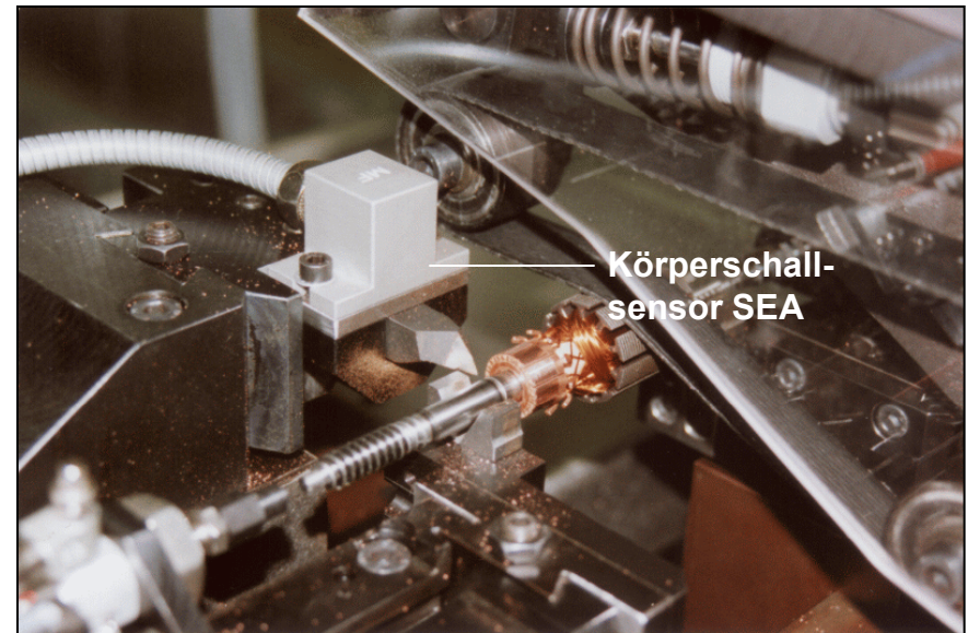
Körperschallsensor unmittelbar am Werkzeug beim Kollektordrehen
